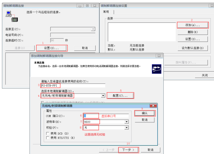
图 5.3-4 STEP7 Micro/WIN 软件中的 10 位通讯模式的设置
