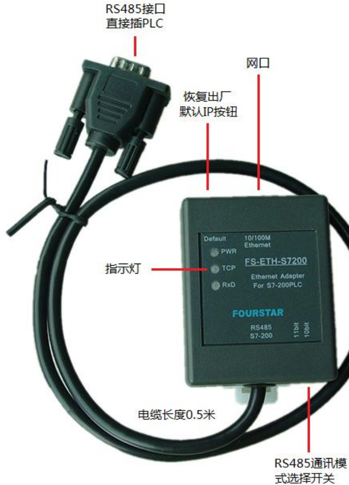
图3-1 FS-ETH-S7200的外部结构及各部件说明
