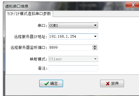
图5.1-3 虚拟串口软件作为TCP Client时的设置
